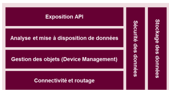
Figure 1 : Architecture fonctionnelle standard d'une plateforme IoT
