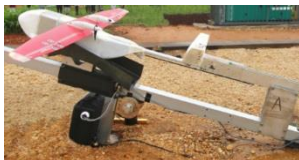
LE DRONE DE ZIPLINE DECOLLE GRACE A UN SYSTEME DE CATAPULTAGE ET LARGUE SES COLIS AU-DESSUS DE LA ZONE DE LIVRAISON
